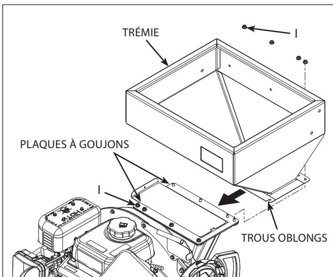
Pour poser la trémie, engager les trous oblongs à l'avant de la trémie sur les quatre goujons de la plaque à goujons avant sous les quatre écrous M6 (I) desserrés précédemment. Remonter la plaque à goujons arrière et les quatre écrous M6 (I) qui avaient été retirés précédemment (Figure 4). Serrer les huit écrous M6 (I).
