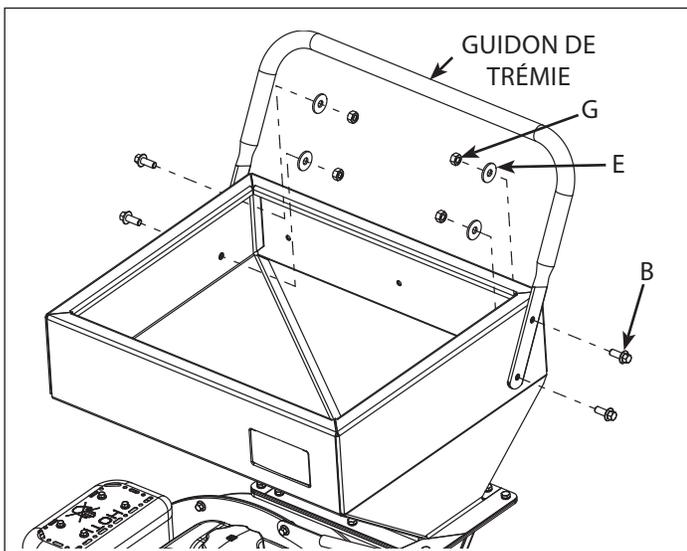
Tenir le guidon de trémie de façon à aligner les trous extérieurs du guidon sur les trous de la trémie et attacher avec quatre vis M8 x 20 mm (B), quatre rondelles M8 (E) et de quatre écrous M8 (G). Enfiler les vis par l'extérieur de la trémie.
