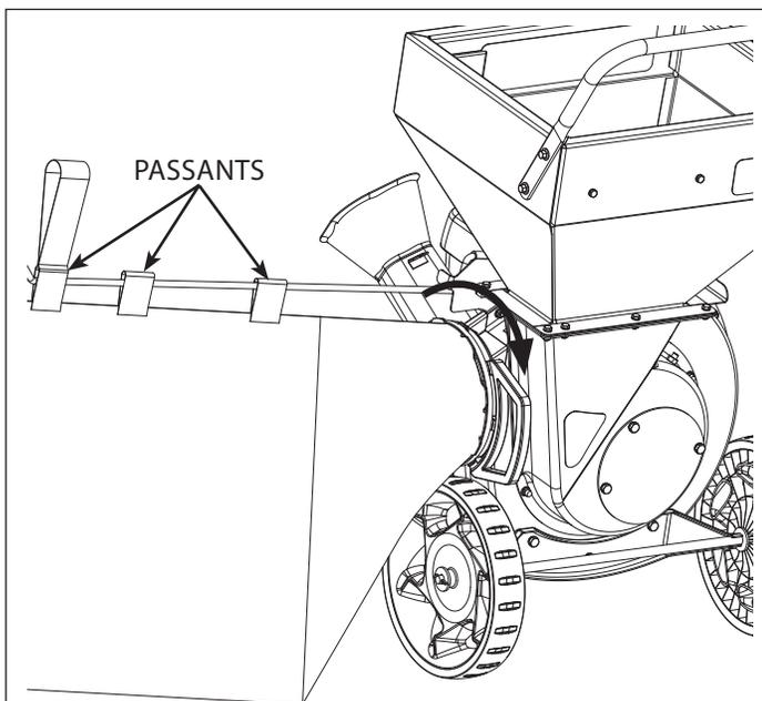
Enfiler les passants du sac collecteur sur la tige-support. Attacher la bride de fixation du sac à la déchiqueteuse en la faisant tourner jusqu'à ce qu'elle soit enclenchée.
