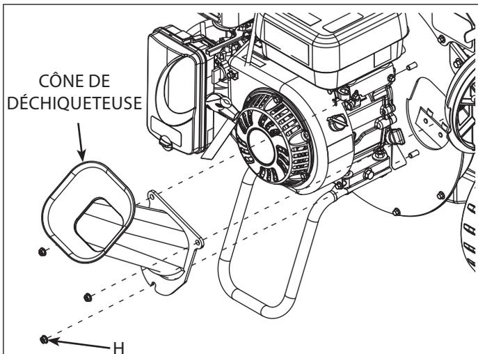
Placer le cône de déchiqueteuse sur les trois goujons filetés M8 x 1,25 po qui dépassent de la plaque du moteur et l'attacher avec trois écrous autobloquants M8 (H). Pivoter le cône et sa base à l'écart du moteur de telle façon que le cône ne touche pas le moteur. Serrer fermement les trois écrous autobloquants M8 (H).
