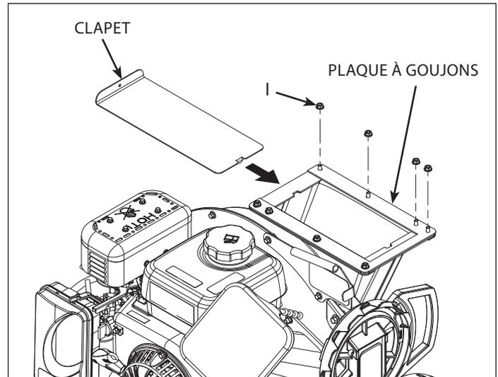
Retirer les quatre écrous M6 (I) arrière et mettre les écrous et la plaque à goujons arrière de côté. Desserrer les quatre écrous M6 (I) avant. **Remarque : Il n'est pas nécessaire de les retirer.** Poser le clapet entre les plaques à goujons comme sur l'illustration.
