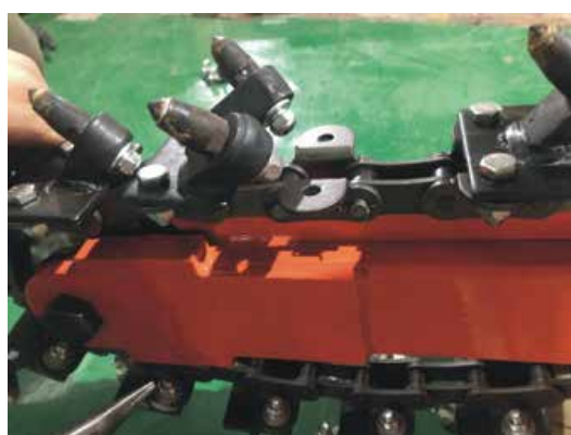
STEP 4: INSTALLATION DE LA PLAQUE À CHAÎNE AVEC ÉPINGLES
