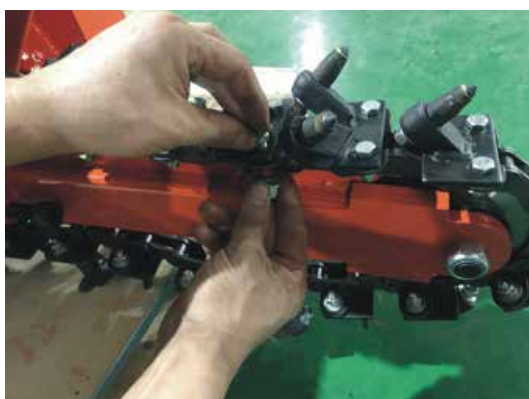
STEP 5: FINITION DE L'INSTALLATION DU PORTE-LAME
