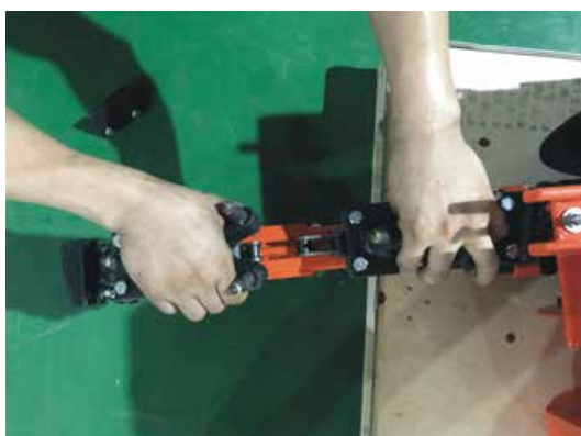
STEP 1: PLACER LA CHAÎNE SUR LES PIGNONS
