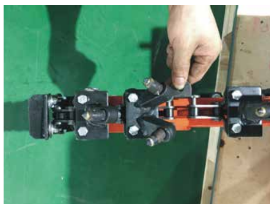
STEP 2: INSTALLATION DE LA PLAQUE DE CHAÎNE
